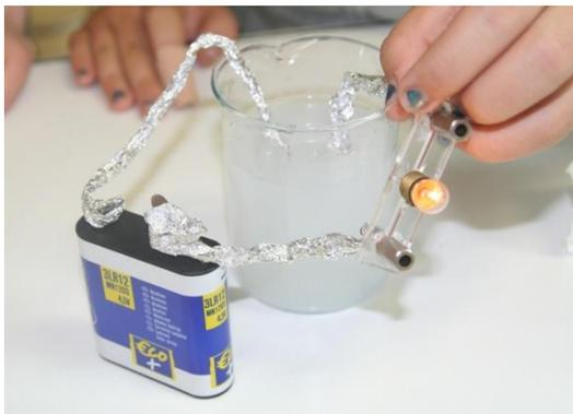
Nous avons fabriqué un circuit en série à l'aide d'une pile, de papier d'aluminium et d'une lampe. Nous avons constaté que plus l'eau contenait de sel, plus la lampe brillait.
