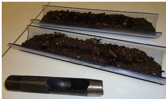
Prélèvement d'un échantillon de tourbe de 2 cm 3 environ à l'aide d'un emporte-pièce
