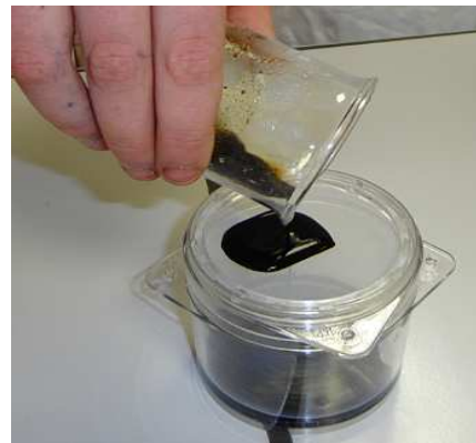
Filtrer le contenu du bœcher sur un tamis de 125 µm au-dessus d'un cristallisoir
