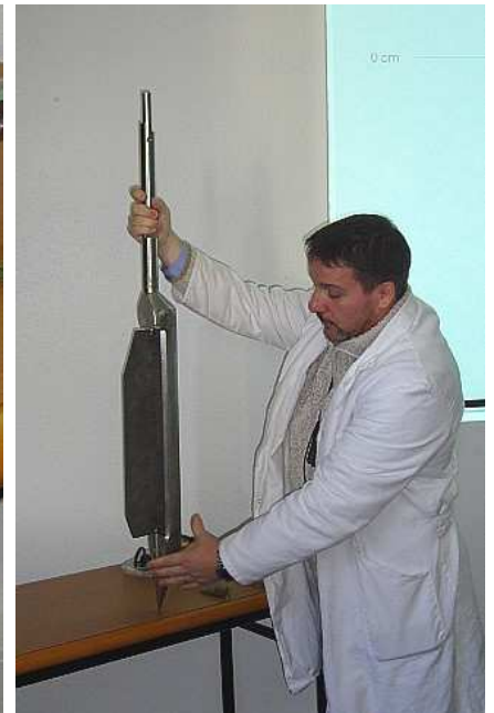
Présentation de l'extrémité d'un carottier par Monsieur Laurent Charrieau, technicien au laboratoire POLEN
