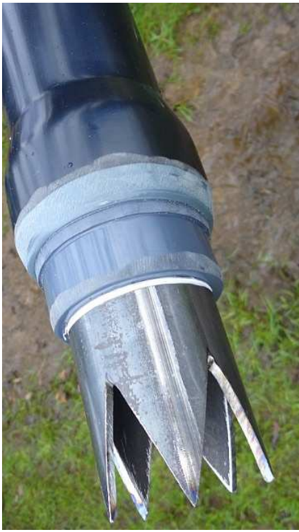
Extrémité du carottier
