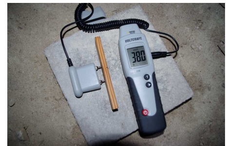
Humidimètre : ici mesure d'un bois trempé dans l'eau pendant 2 jours. (38%) (38%)
