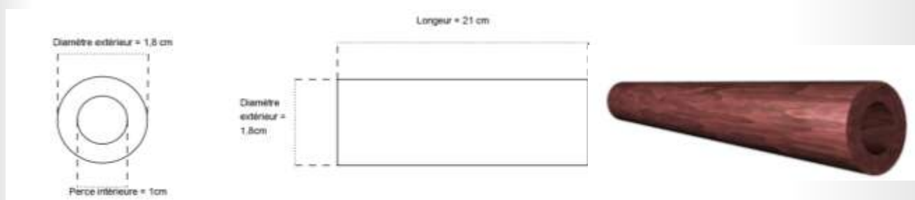
Figure 1 : Cotes et vue tridimensionnelle du conduit
